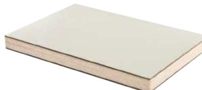
Tablero técnico compuesto por un núcleo de contrachapado fenólico 100% abedul revestido a una o dos caras con compacto fenólico hasta 12 mm de espesor en cada cara.
